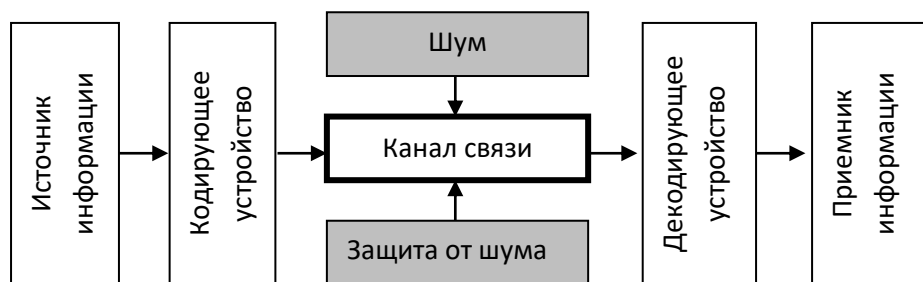
Рисунок 5 – Схема процесса передачи информации по техническим каналам связи
