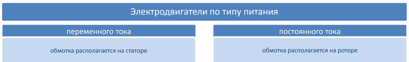
Рисунок 2 – Электродвигатели по типу питания
