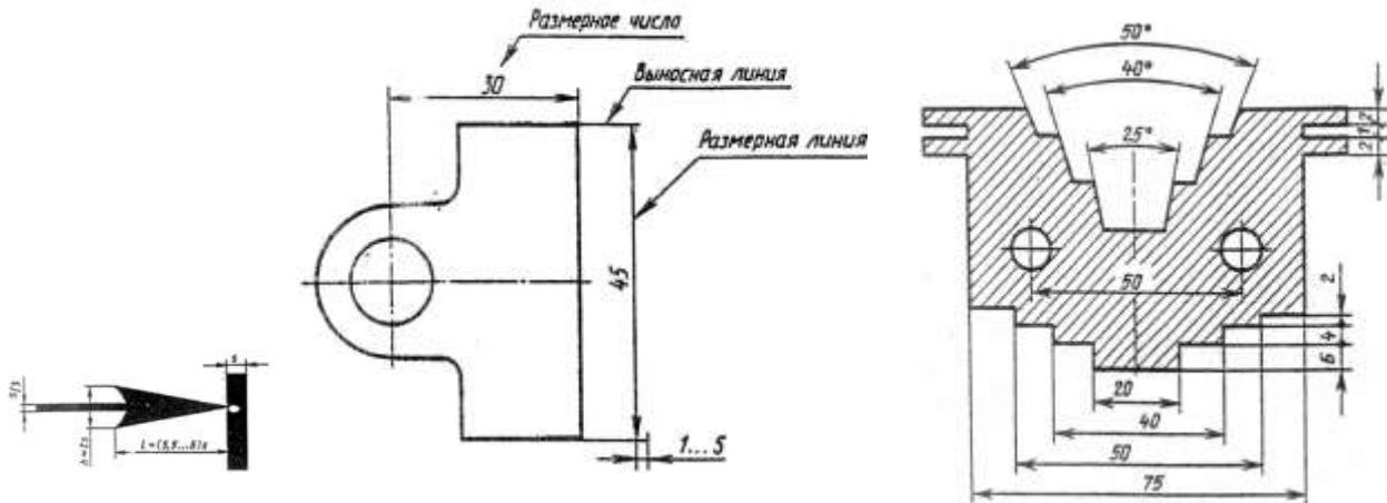
Рис.4 Нанесение размеров
