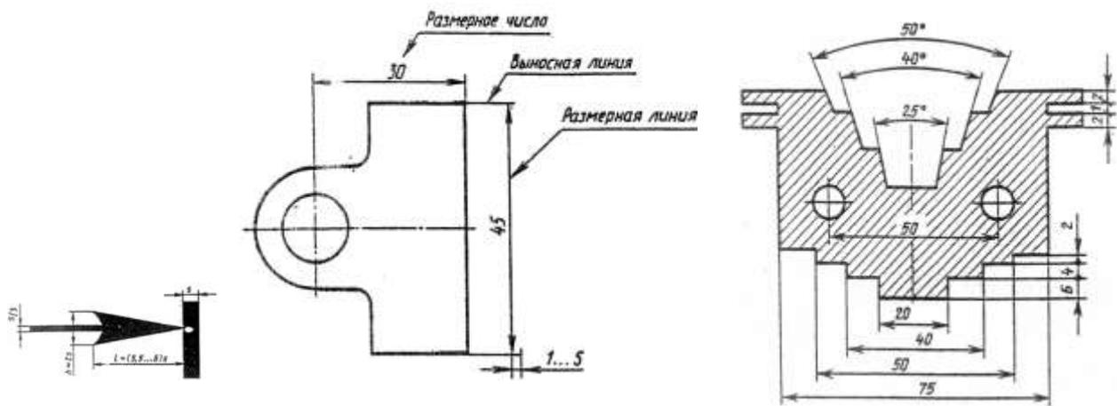
Рис.4 Нанесение размеров
