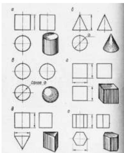
Рис.9 Проекции геометрических тел
