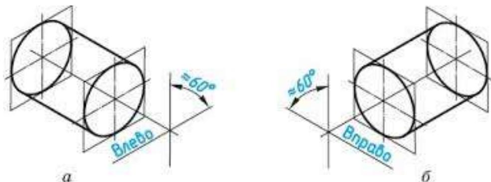
Рис15Аксонометрия цилиндрической поверхности
