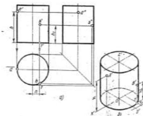
Рис.7 Проекции прямого цилиндра
