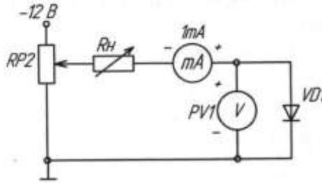
Рисунок 2.2- Схема для снятия ВАХ для прямой ветви
