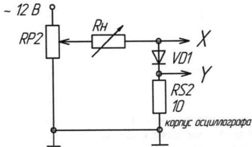
Рисунок 2. 3- Схема для снятия ВАХ для прямой ветви
