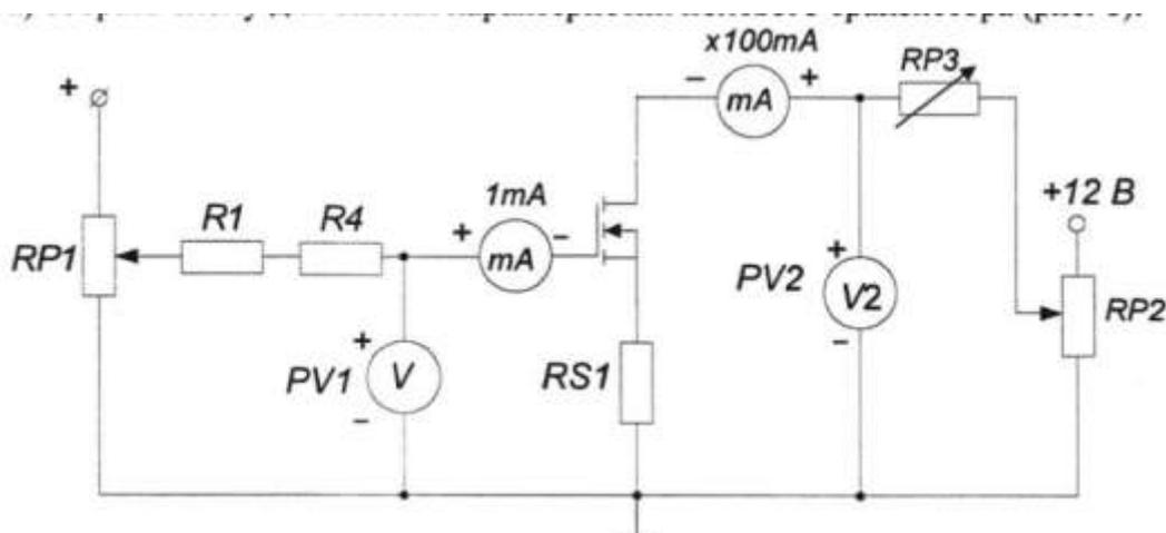
Рис. 4.1. -Схема для снятия характеристик полевого транзистора
