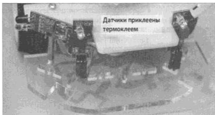
Рис. 12.9. Пример альтернативной установки датчиков при помощи термоклея
