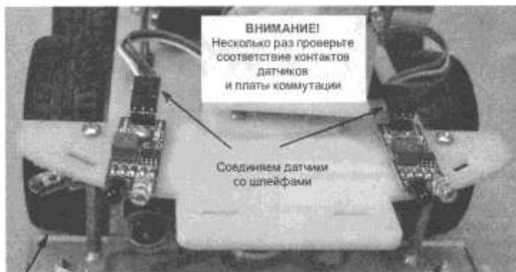
Правый датчик закреплен снизу на одном винте с передним датчиком
