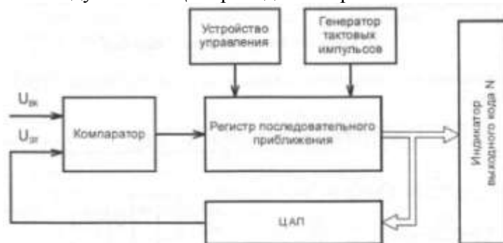
Рис. 30. Структурная схема одного канала АЦП последовательного приближения
