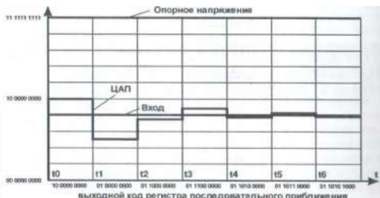
Рис. 2. Принцип работы АЦП последовательного приближения
