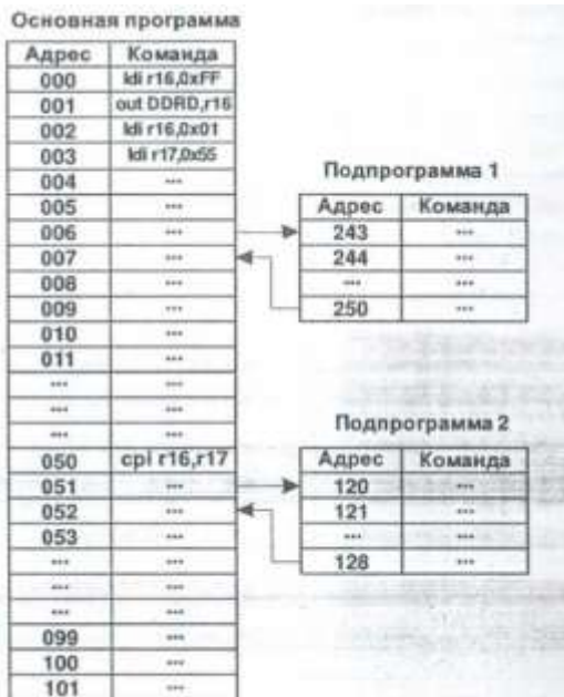
Рис. 1. Принцип работы указателя стека
