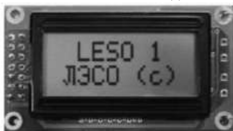
Рисунок 20 – Внешний вид жидкокристаллического индикатора
