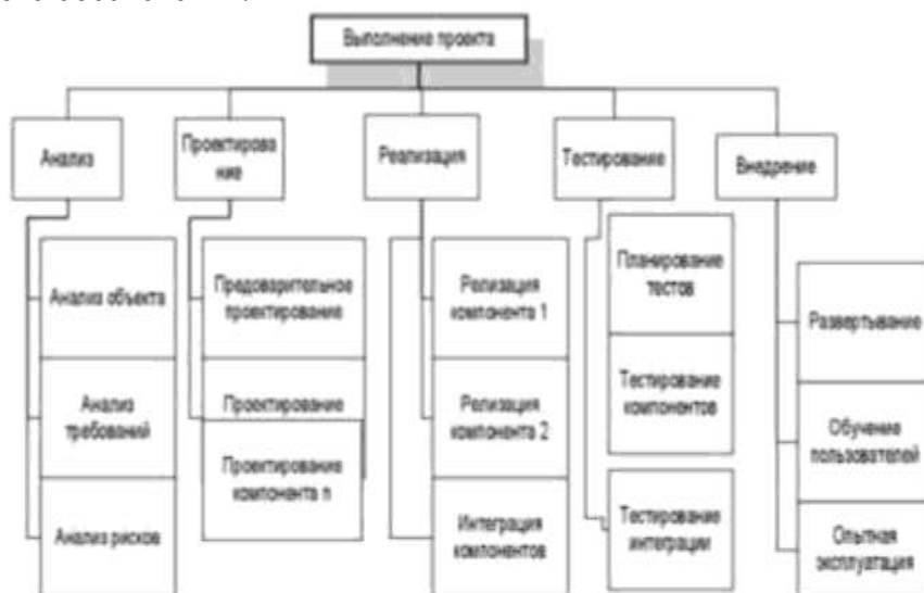
Рис. 1. Декомпозиция задач, которые необходимо решить в процессе выполнения проекта по разработке программного обеспечения
