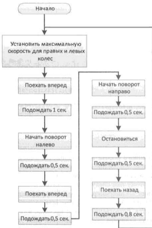
Рис. 7.1. Линейный алгоритм тестовых движений робота
