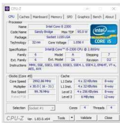
Рис.1. Окно параметров процессора программы CPU-Z
