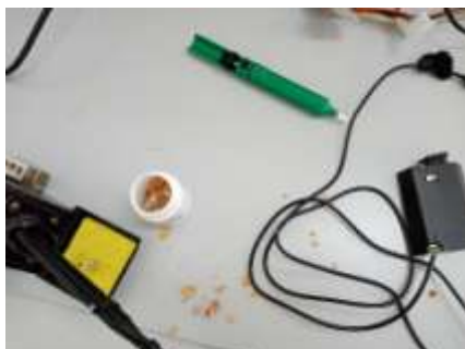
Рисунок 8 – Инструменты, используемые при ремонте блока питания
