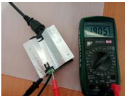
Рисунок 6 – Измерение выходного напряжения
