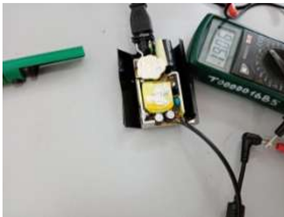
Рисунок 10 – Проверка на работоспособность блока питания
