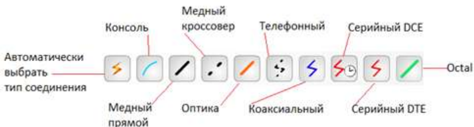
Рис. 7. Типы линий связи
