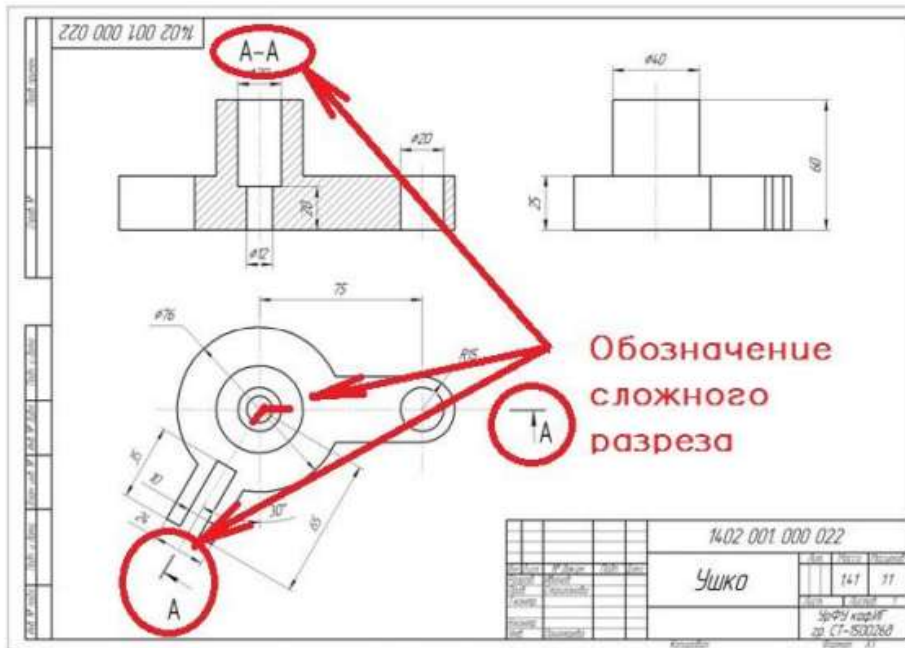
Рис 37 Обозначение сложного ломаного разреза на чертеже
