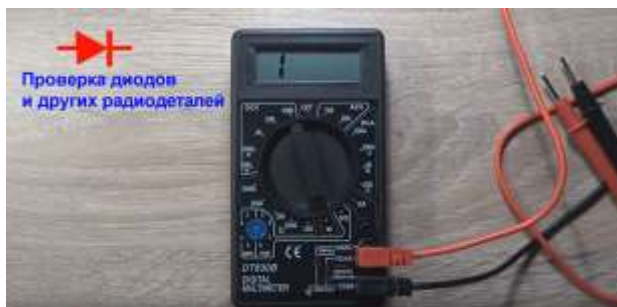
Рисунок 28 – Мультиметр для проверки диодов
