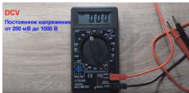
Рисунок 13 - Измерение постоянного напряжения
