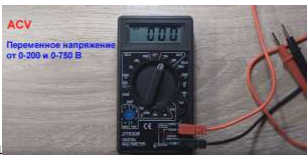
Рисунок 12 - Измерение переменного напряжения
