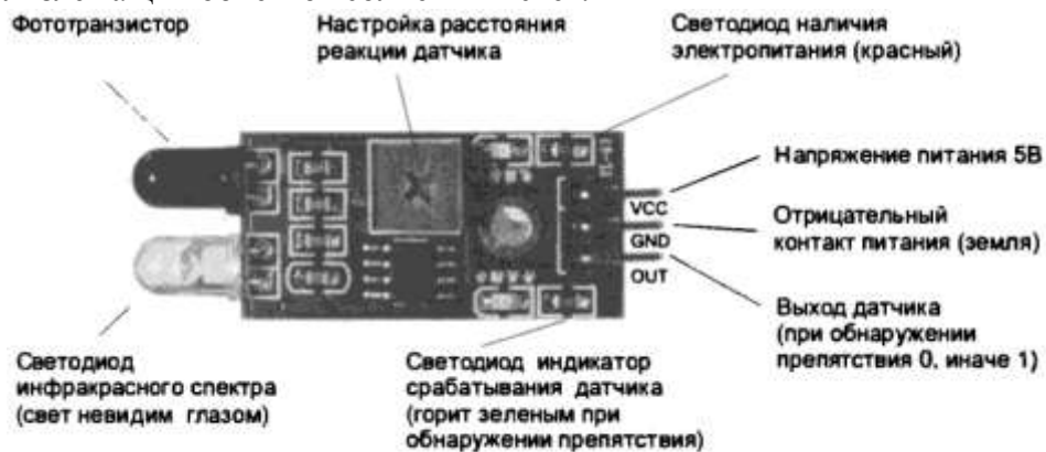
Рис. 12.5. Инфракрасный детектор препятствия
