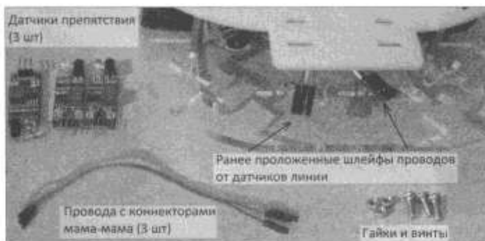
Рис. 12.6. Робот, три датчика препятствия и крепежные винты
