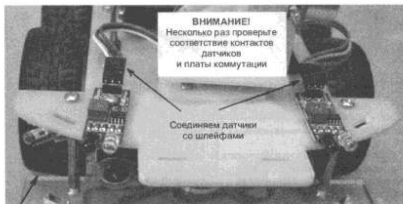
Рис. 12.7. Три датчика препятствия размещены на верхней плате шасси
