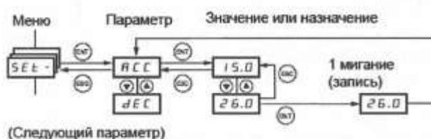
Рисунок 4 –Навигация по параметрам преобразователя
