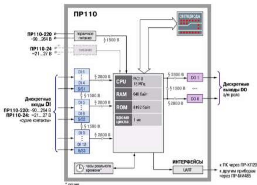
Логика работы программируемого реле PR110 определяется пользователем в процессе программирования с помощью среды «OWEN Logic».
