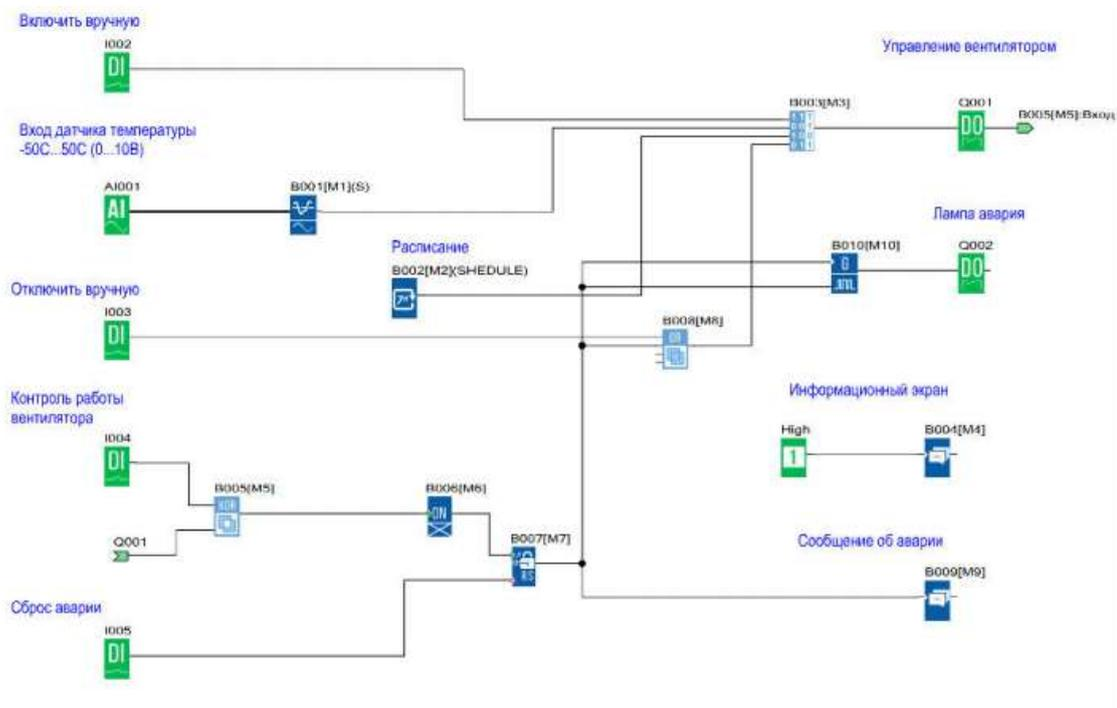
Алгоритм работы программы Температура помещения измеряется датчиком с активным выходом (0..10В), который подключен к первому универсальному входу программируемого логического реле ONI PLR-S. Измеренное значение температуры масштабируется и сравнивается с пороговыми уставками включения и выключения, заданными в блоке порогового триггера B001, которые можно изменять при помощи панели, интегрированной в модуль ЦПУ ONI PLR-S. В
