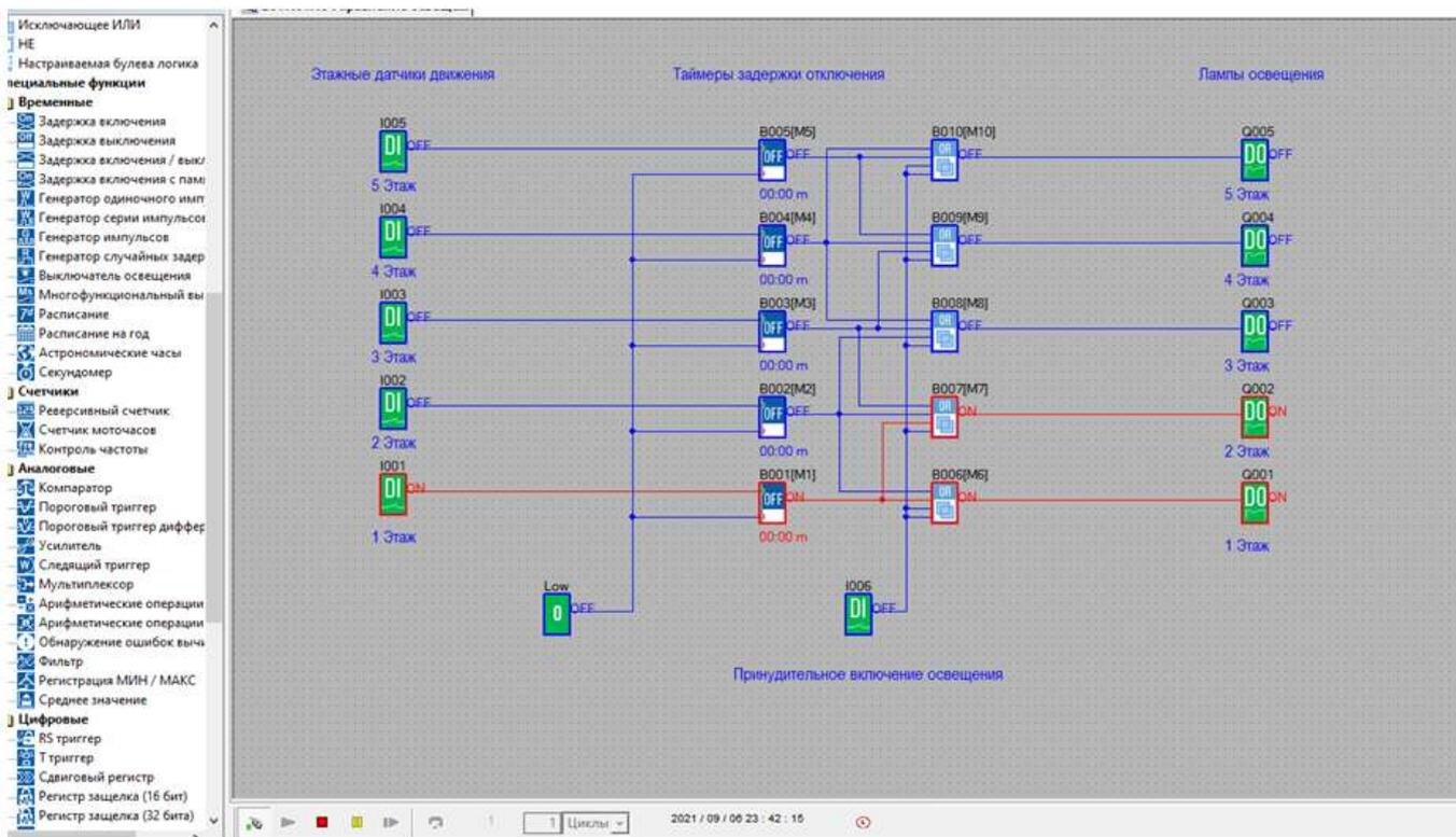
10. При нажатии на элемент вход на 2 этаж, свет загорается на 2 и 3 этаже, а на 1 этаже он гаснет через 15 минут.
