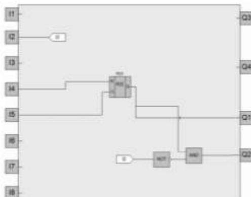
Включение насосов должно сопровождаться миганием зеленого индикатора. Для формирования периодического сигнала для включения/выключения зеленого индикатора введем в программу генератор прямоугольных импульсов BLINK1. На закладке свойств этого блока установим длительность единичного и нулевого сигнала на его выходе одинаковыми и равными 1с. Соединим выход триггера RS1 вход разрешения работы генератора BLINK1.
