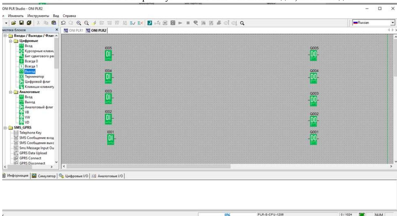
3. Из библиотеки блоков на рабочую область вынести пять элементов задержка выключения
