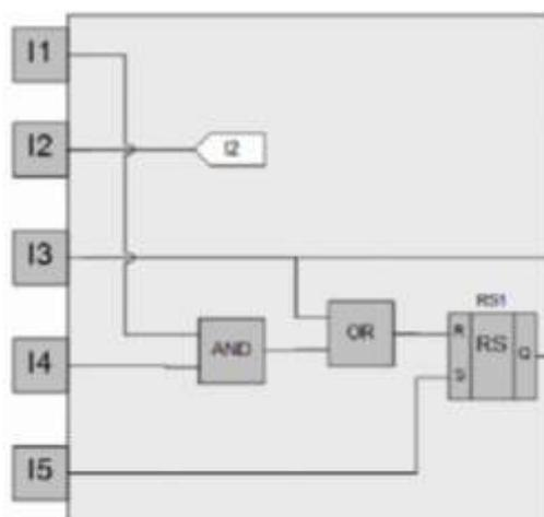
Индикатор красного цвета должен гореть, если одновременно выполняются два условия: не работают насосы (на выходе триггера RS1 присутствует ноль) и уровень воды ниже нижнего уровня (на выходе датчика нижнего уровня присутствует ноль).
