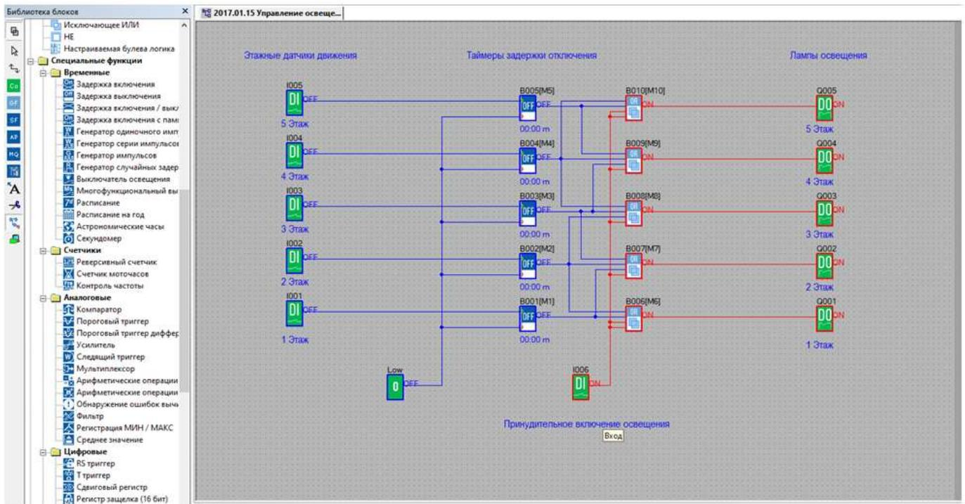
9. Нажмем элемент вход на 1 этаж, свет загорается на 1 и 2 этажах.
