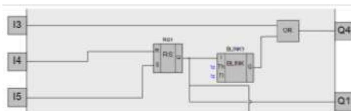
Выключение насосов должно производиться если мы нажмем кнопку «Стоп» и одновременно датчик нижнего уровня будет находиться в состоянии логической единицы (наличие хотя бы при минимальном наличии воды в баке) или если сработает датчик верхнего уровня (бак полон).
