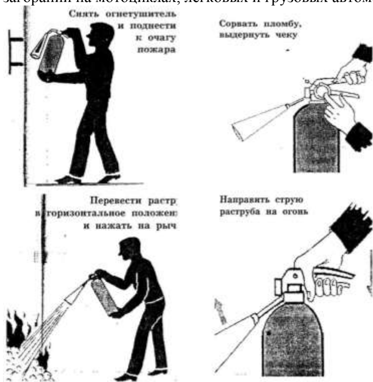
Рис. 3. Приведение в действие ручного углекислого огнетушителя.
