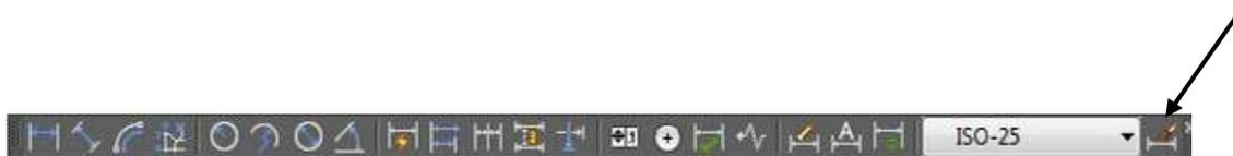
Размерный стиль – это поименованная совокупность значений всех размерных переменных, определяющая вид размера на рисунке. Все размеры создаются с использованием **текущего размерного стиля**.
