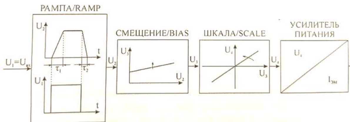
Рисунок 3 – Структура и работа усилителя сигнала
