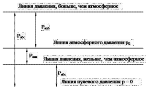
Рис.1. - К понятию избыточного давления и вакуума.
