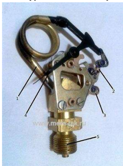
Рисунок 1 – Пружинный манометр типа ОБМ
