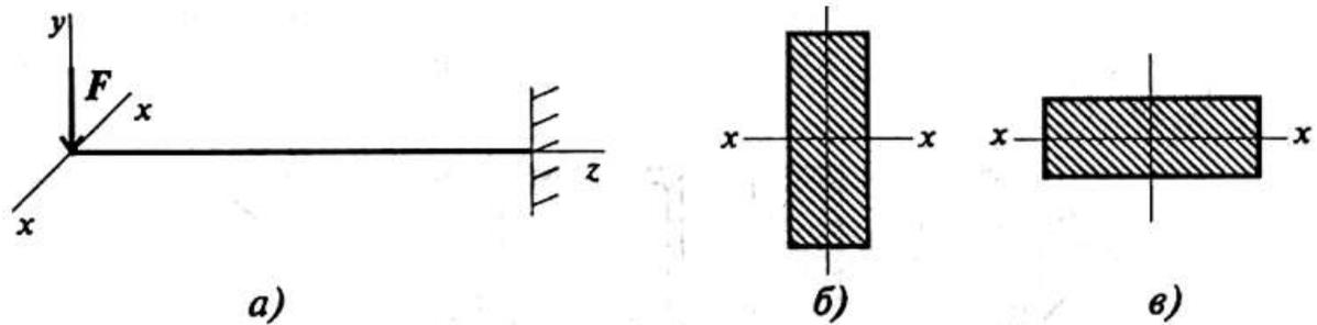
Рисунок 2 – Сравнение сопротивления изгибу двух прямоугольных сечений
