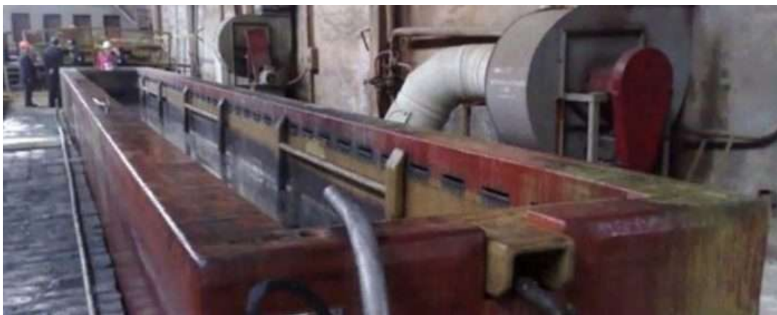
Травление ортофосфорной кислотой
