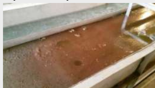
Ржавчина и отложения в результате травления
