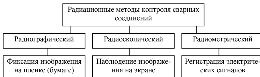
Схема 2,1. Способы детектирования радиографической информации
