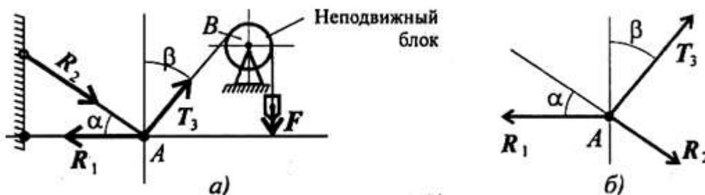
а) Силы, действующие на шарнир A .
