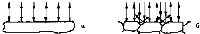
Рис. 2. Схема отражения световых лучей от поверхности полированного (а) и подвергнутого травлению (б) микрошлифа.
