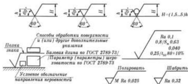
Рисунок 2 – Обозначения шероховатости поверхности
