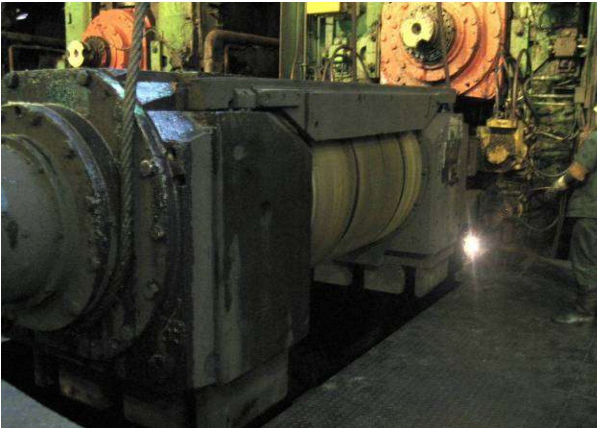
Рис.9. Смена нижнего опорного вала электромостовым краном
