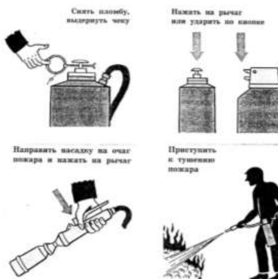
Рис. 1. Приведение в действие воздушно-пенного огнетушителя.
