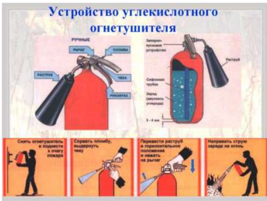
рис.2 Углекислотный огнетушитель
