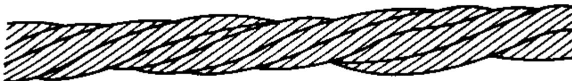
Рис. 2.4. Местное уменьшение диаметра каната на месте разрушения органического сердечника
