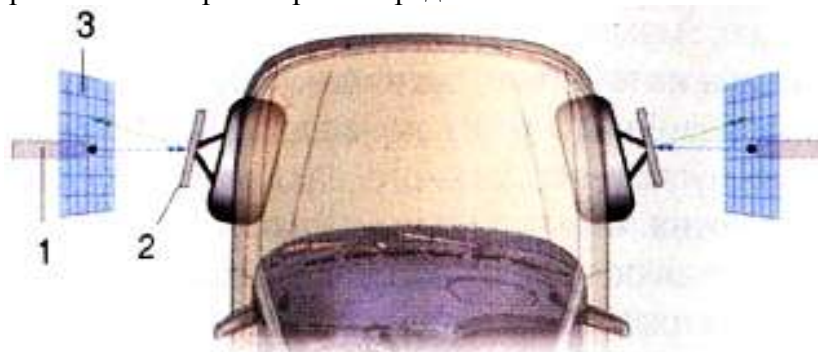
Рисунок 3 - Оптический стенд для измерения углов установки колес: 1 – излучатели; 2 – зеркала; 3 – размеченные экраны
