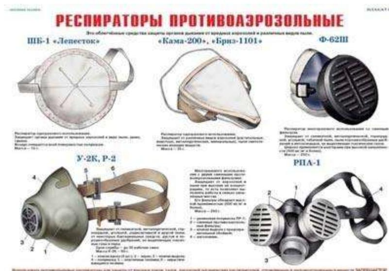
**Респиратор Р-2** представляет собой фильтрующую полумаску, снабжённую двумя клапанами входа и одним клапаном выхода (с предохранительным экраном), оголовьем, состоящим из эластичных тесёмок и носовым зажимом.
