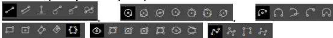
Для нанесения размерных линий на чертеж (линейный, радиальный, диаметальный, угловой и др.) используются соответствующие команды панели инструментов «РАЗМЕРЫ».
