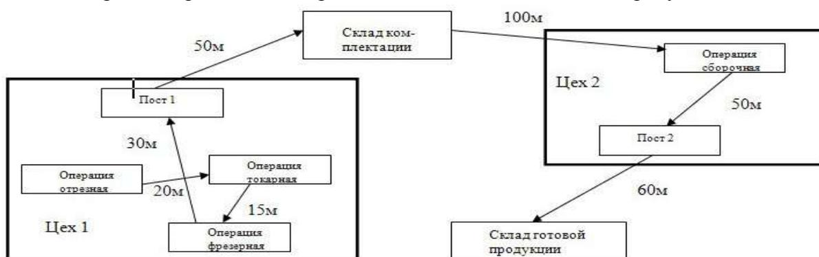
Рисунок 1 – Текущее состояние обработки детали в цехах №1 и №2
