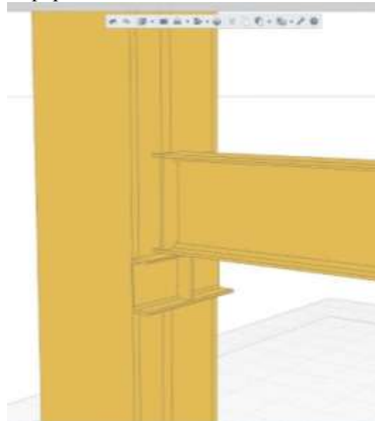
Рисунок 14.2 - Модель узла опирания двутавровой балки на колонну через опорный столик из швеллера
