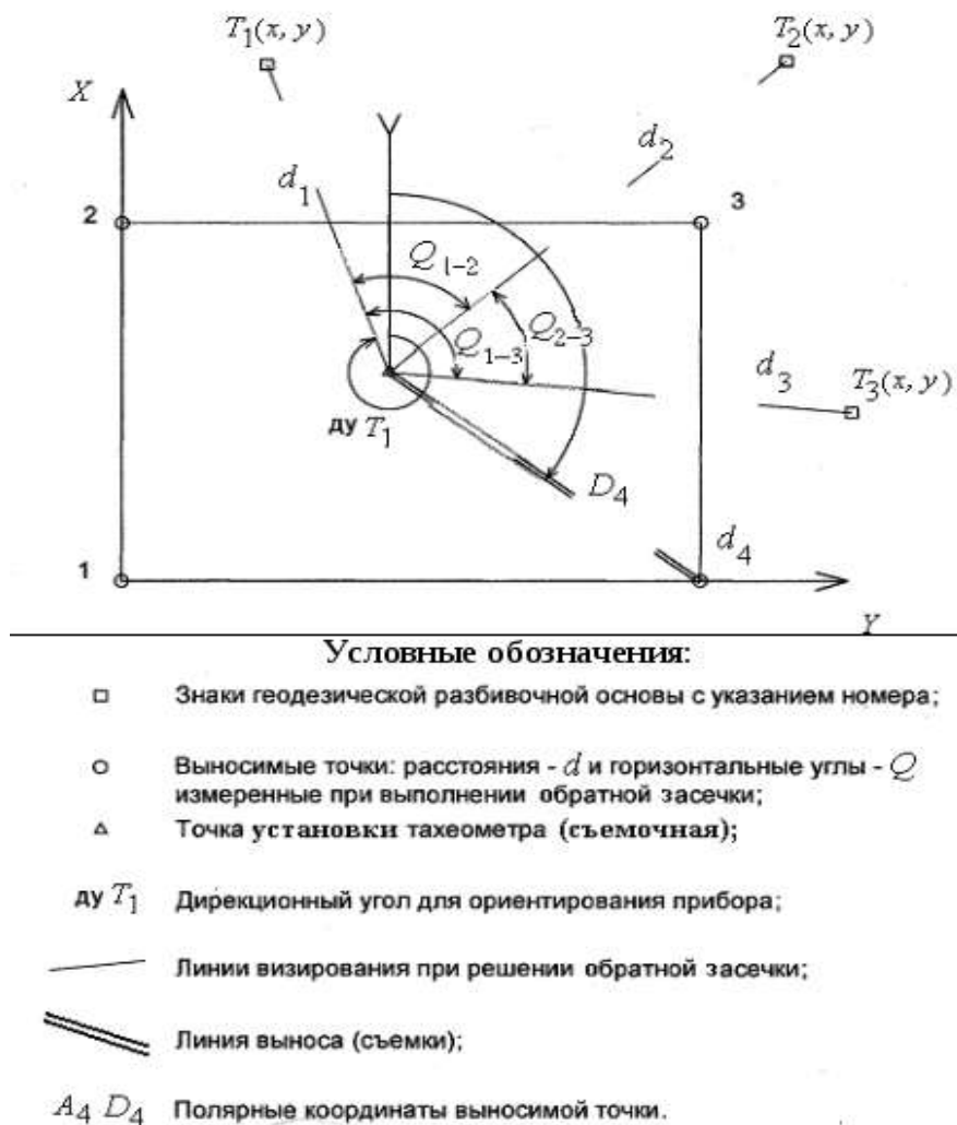
Рисунок 46. Схема выноса основных осей здания с помощью тахеометра с его предварительным ориентированием
