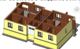
Рис. 7. Модель со скрытым внешним слоем кирпичной кладки
