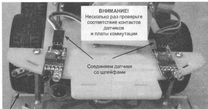
Рис. 12.7. Три датчика препятствия размещены на верхней плате шасси
