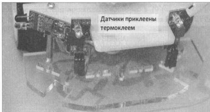
Рис. 12.9. Пример альтернативной установки датчиков при помощи термоклея
