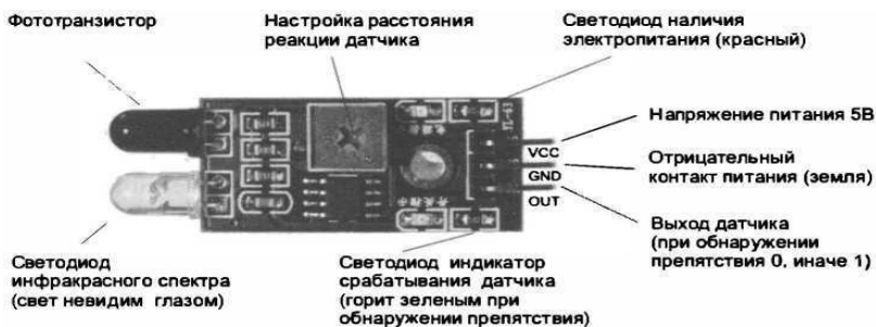
Рис. 12.5. Инфракрасный детектор препятствия
