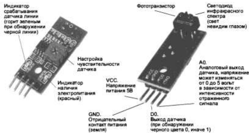
Рис. 9.5. Инфракрасный датчик отражения TCRT 5000: а — лицевая сторона; б — обратная
