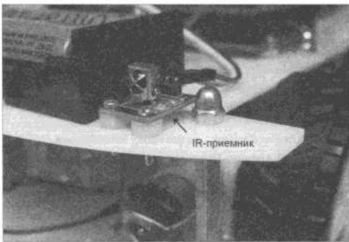
Рис. 8.6. Робот, оснащенный IR-приемником
