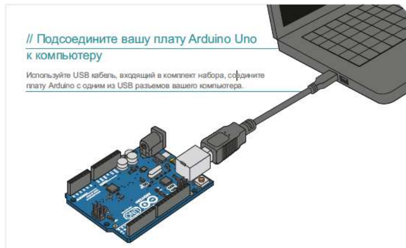
Рисунок 6 – Подключение Ардуино к ПК
