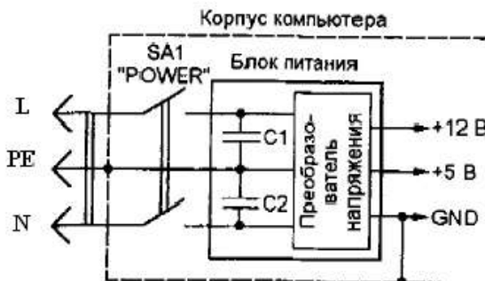
Рисунок 2 - Типовая схема подключения СВТ к питающей сети
