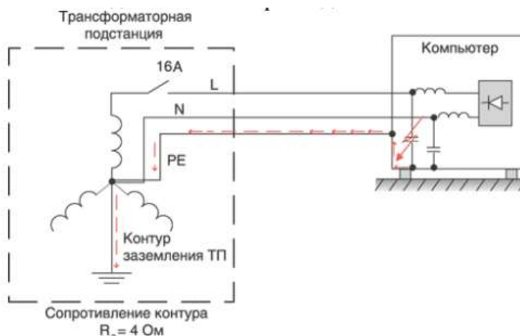
Рисунок 1 - Система заземления СВТ
