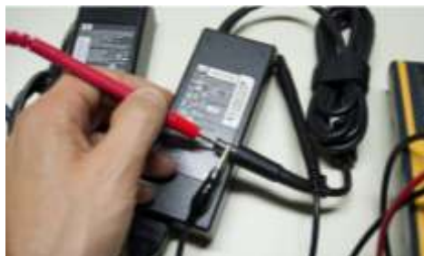
Рисунок 7 – Измерение выходного напряжения на штекере зарядного устройства
