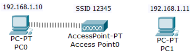
Рисунок 22 - Динамическая связь точки доступа и беспроводного адаптера Меняем динамический адрес на статический (рисунок 23).
