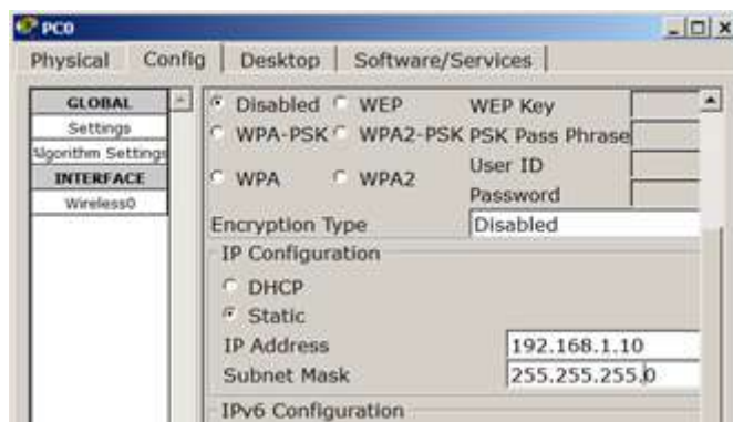
Рисунок 23 - Меняем динамический адрес на статический
