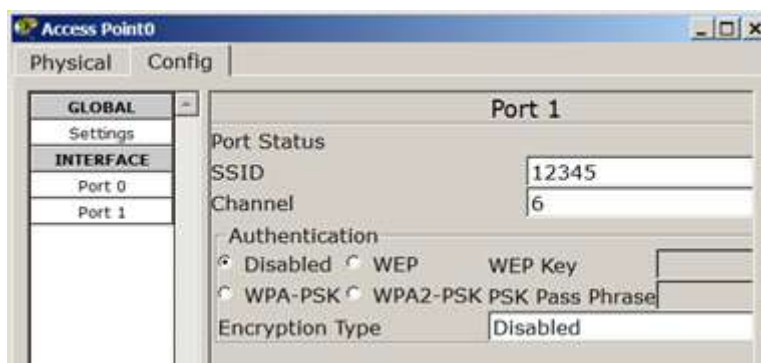
Рисунок 18 - Задаем SSID на точке доступа
