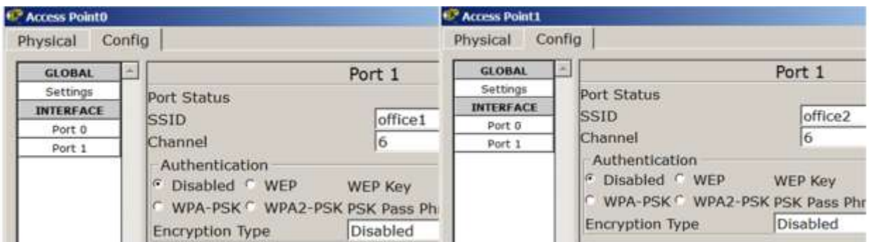
Рисунок 15 - Задаем SSID на точках доступа
