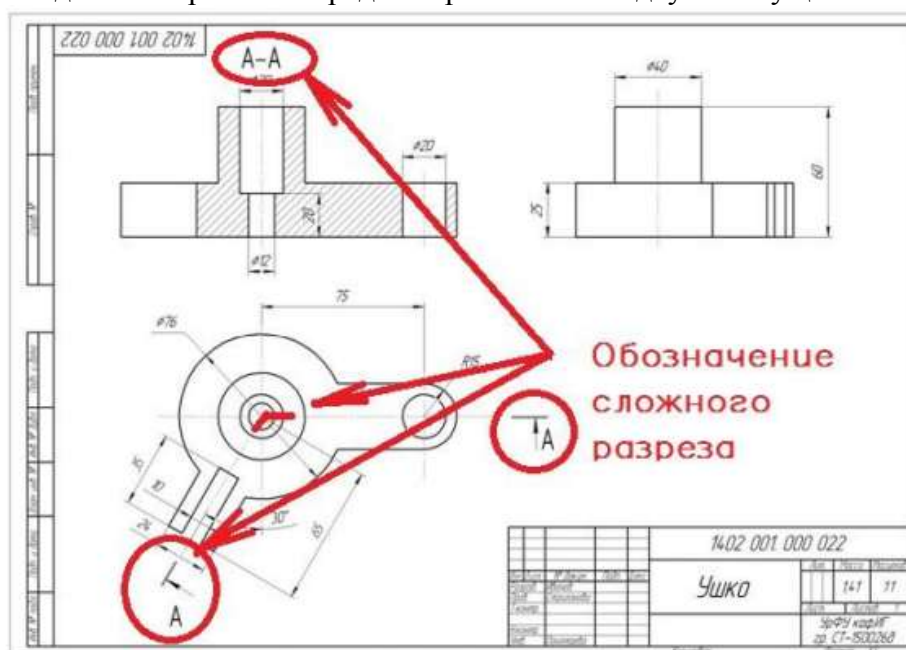
Рис 37 Обозначение сложного ломаного разреза на чертеже
