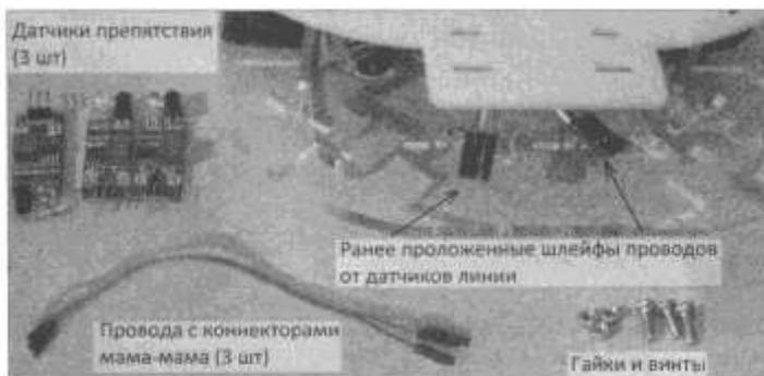
Рис. 12.6. Робот, три датчика препятствия и крепежные винты
