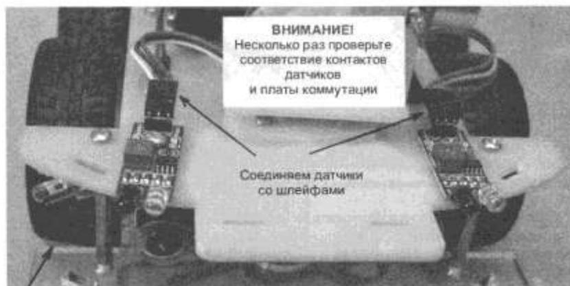
Правый датчик закреплен снизу на одном винте с передним датчиком
