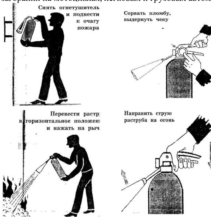
Рис. 3. Приведение в действие ручного углекислого огнетушителя.
