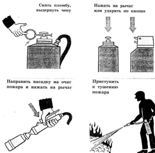
Рис.1. Приведение в действие воздушно-пенного огнетушителя.
