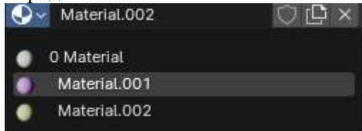
5. Материалы можно переименовывать как непосредственно в слоте, так и через блок выбора/создания материала. Кнопка со знаком с двумя листочками создает новый материал в текущем слоте путем копирования текущего материала. Крестик удаляет материал, а включенная кнопка с щитом позволяет сохранять материал, даже если он не используется ни одним объектом. Отметим, пока вы не закрыли файл, все неиспользуемые материалы сохраняются.
