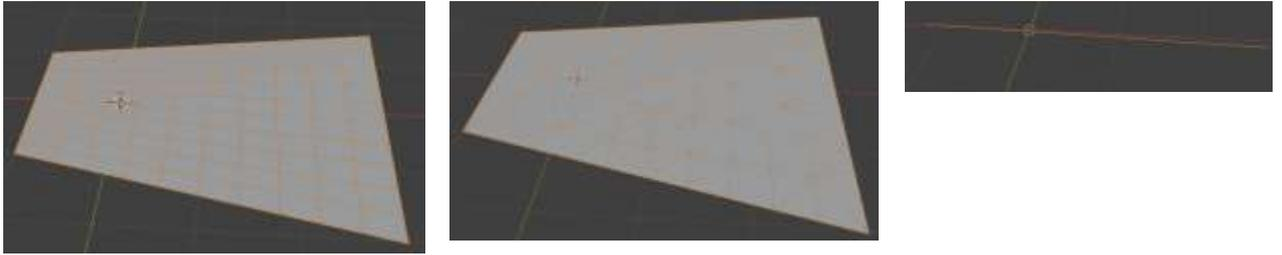
18. Часто после такого модификатора требуется разрыв «связей» между гранями. Модификатор *Edge Split* разбивает, дублирует ребра внутри сетки. Это в дальнейшем позволяет работать с каждым полигоном сетки отдельно.
