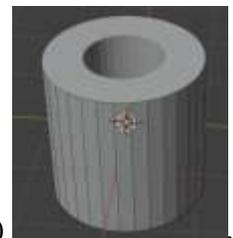
Создается толщина объекта со смещением 0,5 м внутрь (Offset = -1)
