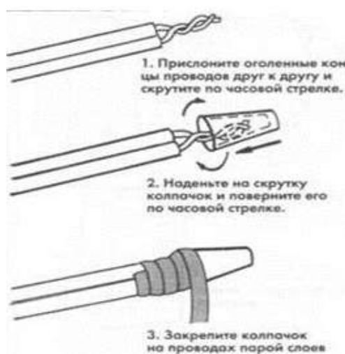
Рисунок 2 – Соединение жил кабеля
