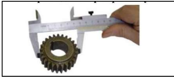
Рис.58 Определение диаметра вершин зубьев колеса
