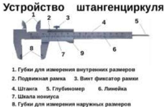
Рисунок 1 Устройство штангенциркуля
