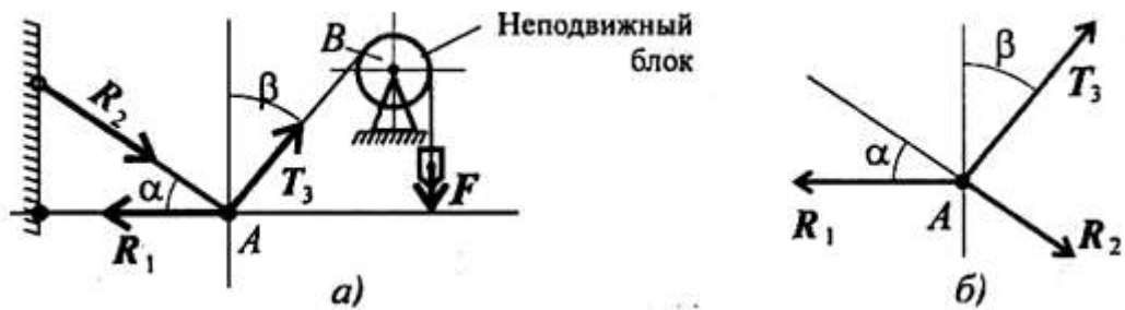
а) Силы, действующие на шарнир А. б) Система сходящихся сил. Рисунок 1 – Груз, подвешенный на стержнях и канатах
