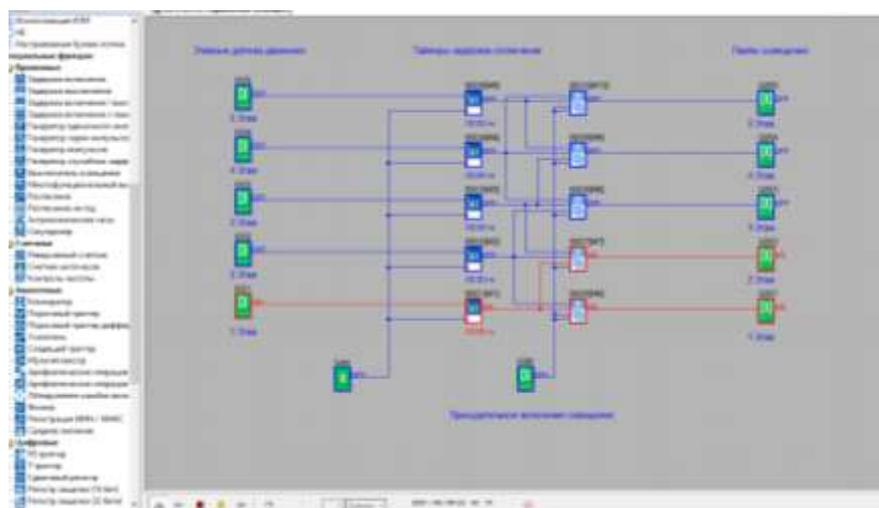
12. При нажатии на элемент вход на 2 этаж, свет загорается на 2 и 3 этаже, а на 1 этаже он гаснет через 15 минут.
